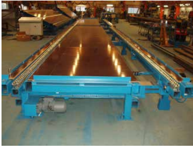
Regelstation FT1000 utrustat med hjulbanor
