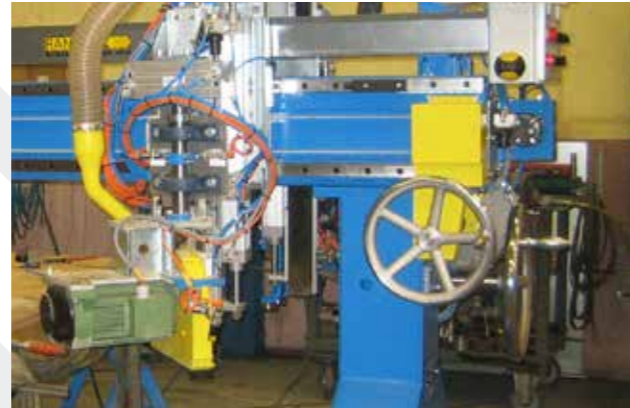
Double System kan likaväl utrustas med en manuell spikportal (NB1000) som en helautomatisk CAD/CAM-styrd spikportal (NB3000).
