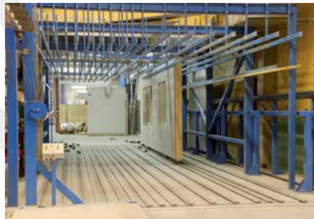
Med fällbara horn möjliggörs uttransport av väggelementet i vertikalt läge till ett vägglagersystem
