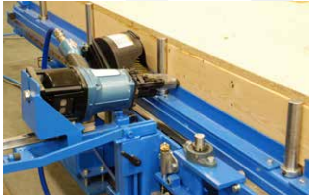
Regelstationen är utrustad med viktbalanserade spikverktyg som löper längs med stationen för exakt och säker spikning av regelverket.
